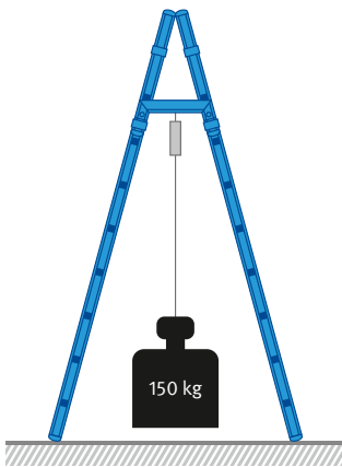
Abb. 11 Steckleiterverbindungsteil belastet mit Prüflast
